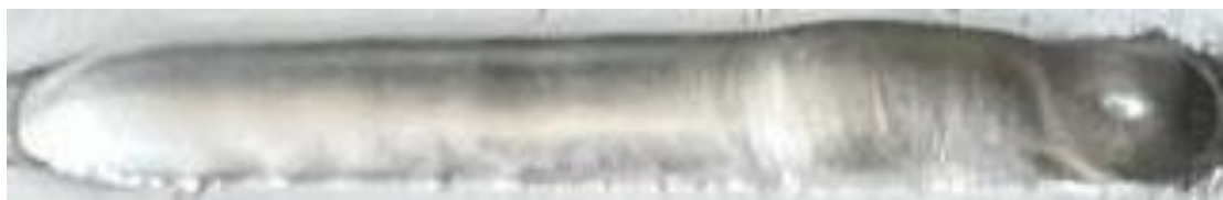
Рисунок 17 – Первый слой наплавки при подаче проволоки сонаправленно движению плазматрона
