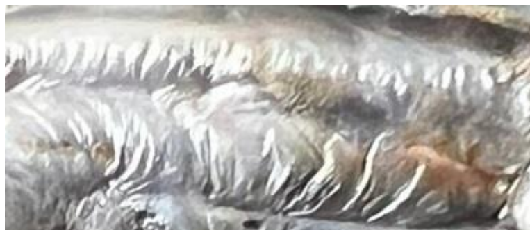
Рисунок 21 – Три слоя наплавки при положении пластины в позиции вертикально
