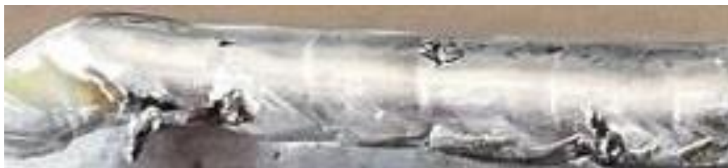
Рисунок 19 – Первый слой наплавки при положении пластины в позиции вертикально
