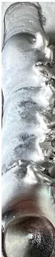
Рисунок 14 – Первый слой наплавки при подаче проволоки сбоку
