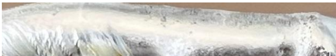
Рисунок 20 – Второй слой наплавки при положении пластины в позиции вертикально
