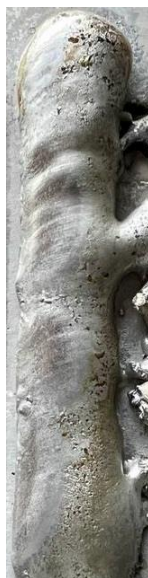
Рисунок 18 – Второй слой наплавки при подаче проволоки сонаправленно движению плазматрона
