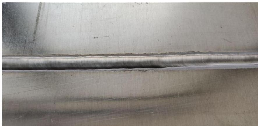
Рисунок 16 – Сварной шов полученный при плазменной сварке
