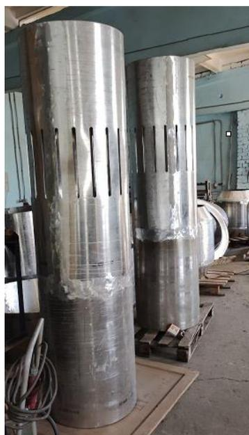
Рисунок 1 – Труба из алюминиевого сплава диаметром 820мм и толщиной стенки 5мм
