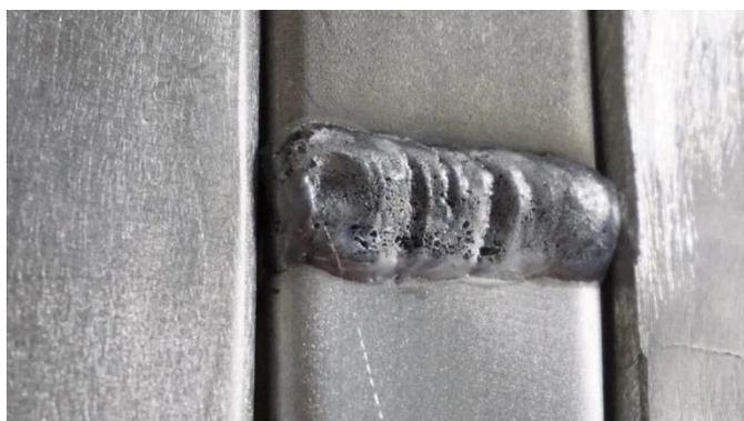
Рисунок 3 – Сварочный шов с образованием пор
