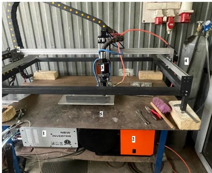
1 –Источник питания, 2 -механизм подачи проволоки, 3 – плазматрон,
