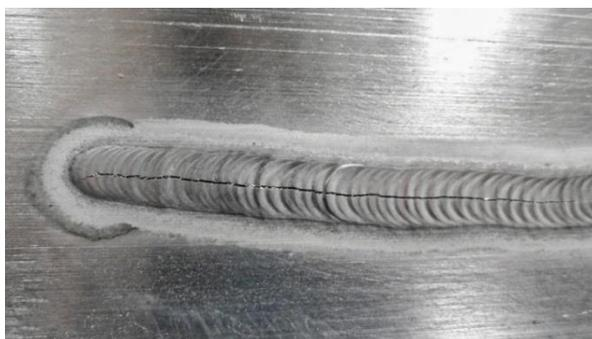
Рисунок 4 – Горячая трещина в сварном шве
