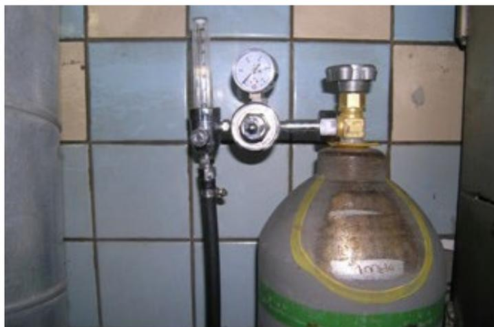
Рисунок 6 – Баллон с аргоном на сварочном посту
