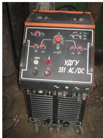
Рисунок 5 – Сварочный источник питания УДГУ-351
