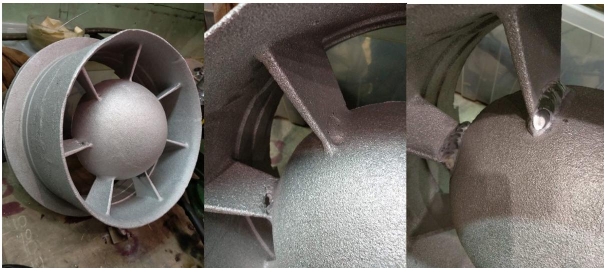
Рисунок 7 – Пример исправления дефектов на отливке корпуса направляющего аппарата
