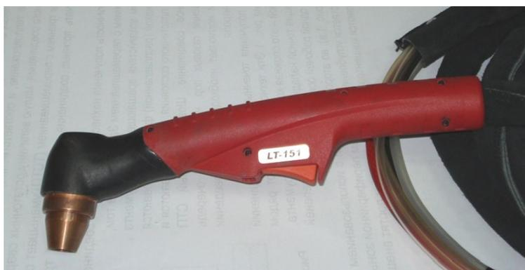
Рисунок 9 – Модернизированный плазматрон для ремонтной сварки деталей из алюминиевых сплавов
