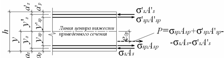
Рис. 2.3. Схема усилий предварительного напряжения арматуры в поперечном сечении железобетонного элемента
