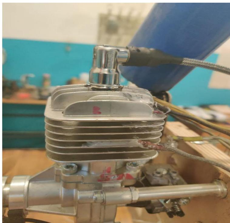
Рисунок 20 – Термопары, закреплённые на цилиндре
