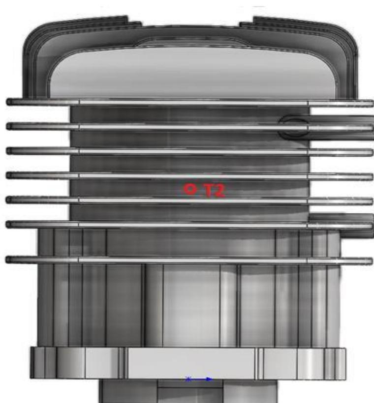
Рисунок 17 – Место установки термопары №2
