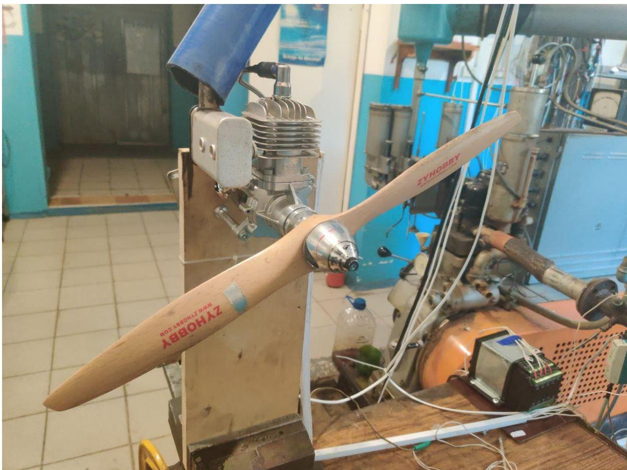
Рисунок 15 – ДВС, закрепленный на верстаке, и оснащенный системами топливоподачи, зажигания, тахометром и термопарами.
