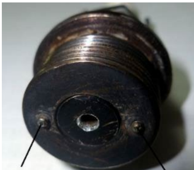
Рисунок 12 - Структура камеры сгорания, оснащённой ионизационными датчиками
