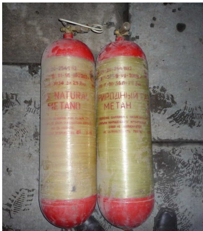
Рисунок 13 – Газовый баллон марки БА-51-20-254/1262 ТУ 4591-001-29416612-2005 с запорно-предохранительной арматурой
