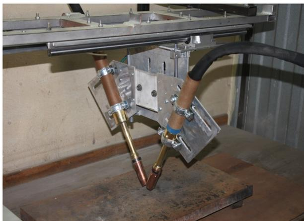
Рис. 2.3. Установка для автоматической двухдуговой наплавки
