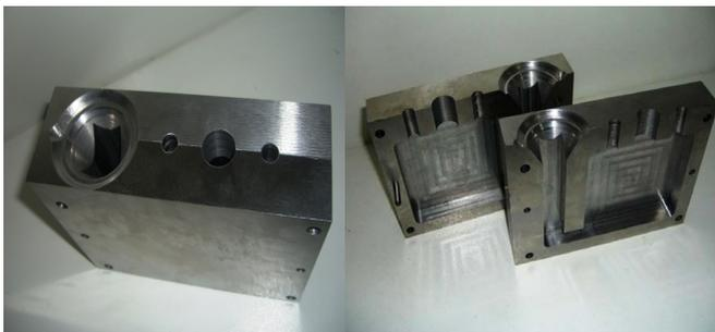
Рис. 1.3. Форма с нижней литниковой системой
