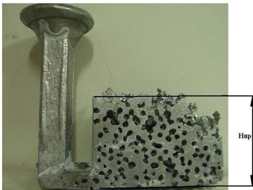
Рис. 1.4. Определение глубины пропитки  $H_{пр}$
