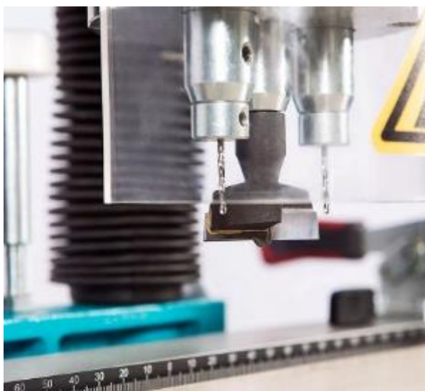
Рисунок 13 – Защитный экран шпоночно-фрезерного станка
