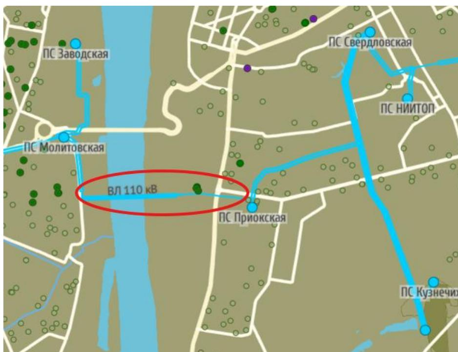
Рисунок 2 – Новая линия ВЛ-110 кВ, которая подключается к подстанции 110/6 кВ «Приокская» на стороне 110 кВ
