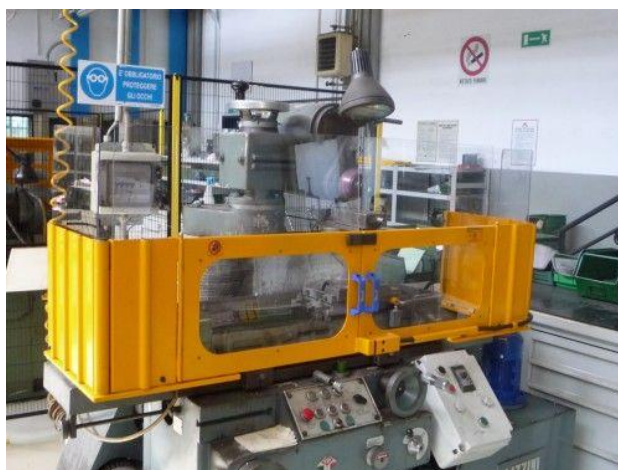
Рисунок 11 – Фрезерный станок со звукоизолирующим кожухом из оргстекла
