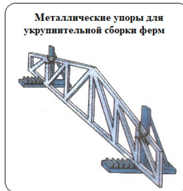
Рисунок Б.6 – Строповка и укрупнение ферм
