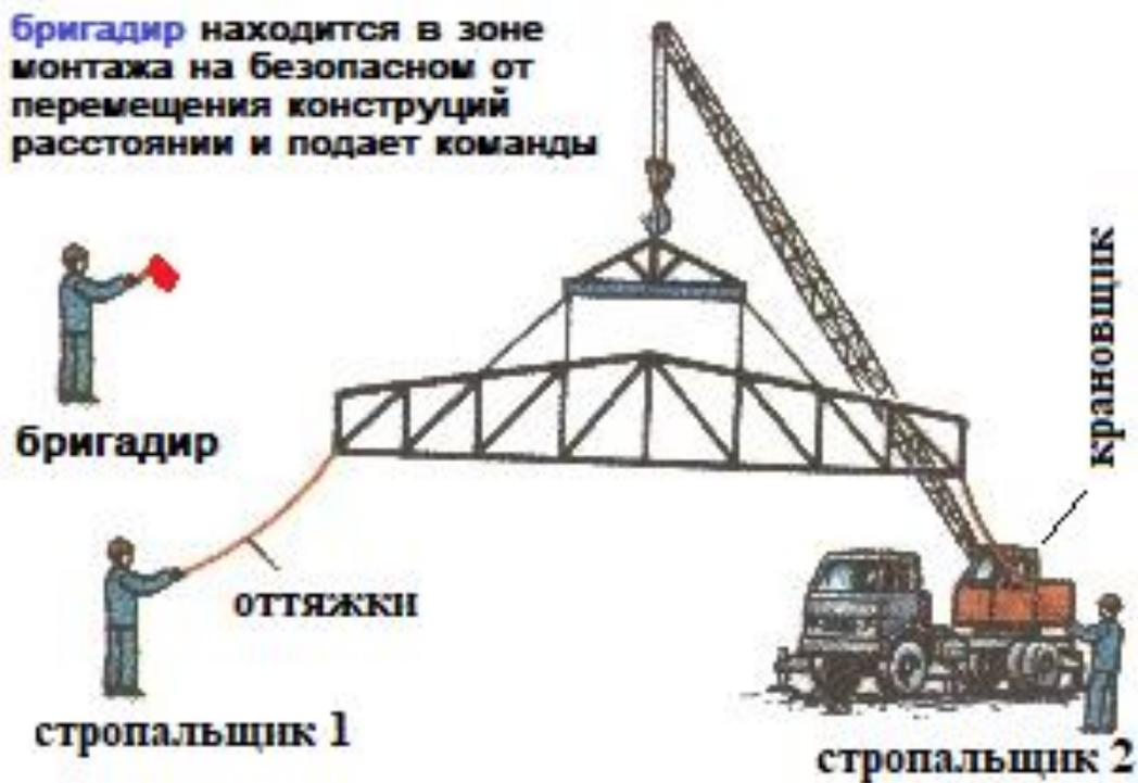
Рисунок Б.7 – Процесс подъема фермы при монтаже
