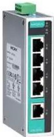
Рисунок 13 – Коммутатор EDS-205A
