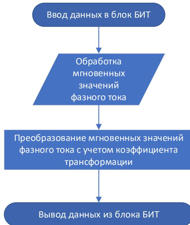
Рисунок 5 - Алгоритм функционирования блока измерения тока
