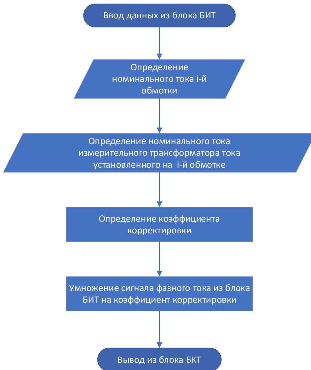
Рисунок 7 - Алгоритм функционирования блока корректировки тока
