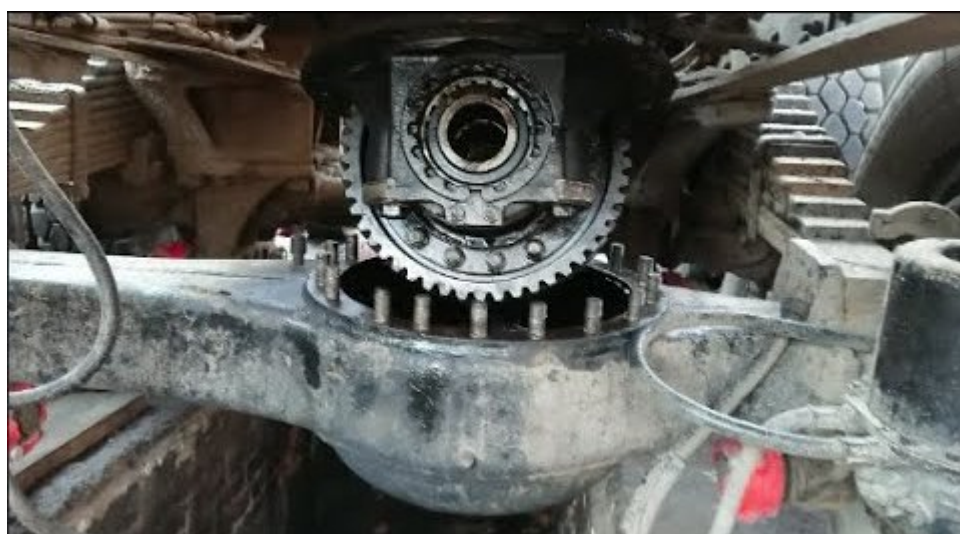
Рисунок 14 – Демонтаж редуктора заднего моста КАМАЗ
