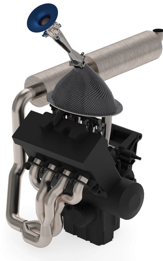
Рисунок 13 – Впускная и выпускная система немецкой команды «Формула Студент»
