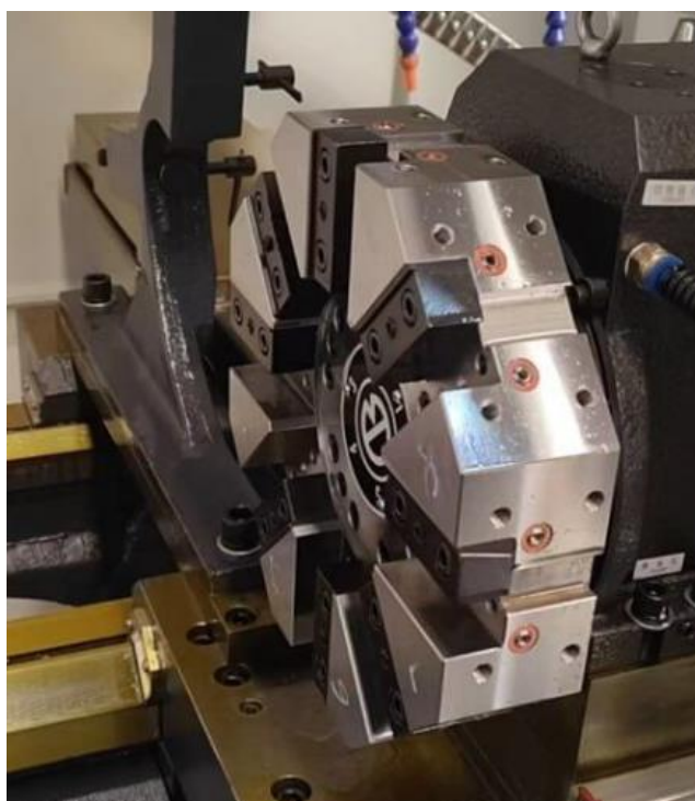
Рисунок 6 – Револьверная головка станка с ЧПУ SK6140
