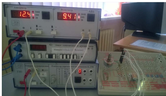
Рис. 7.2. Экспериментальная установка: измерительный блок АВ1, включающий в себя цифровые вольтметр и амперметр; прибор комбинированный цифровой Щ4300; генератор напряжения ГН1; стенд с переменным сопротивлением
