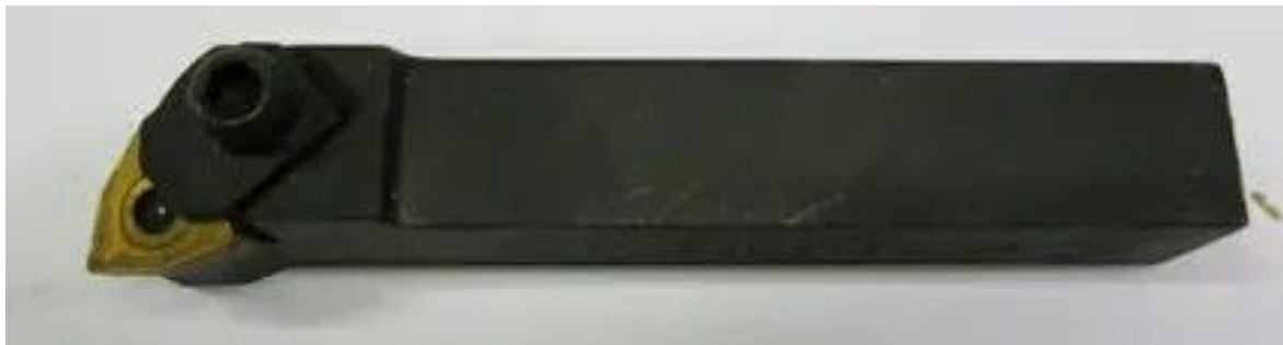
Рисунок 24 - Резец MWLNL2016K06 T15K6 ТУ 2-035-892-82
