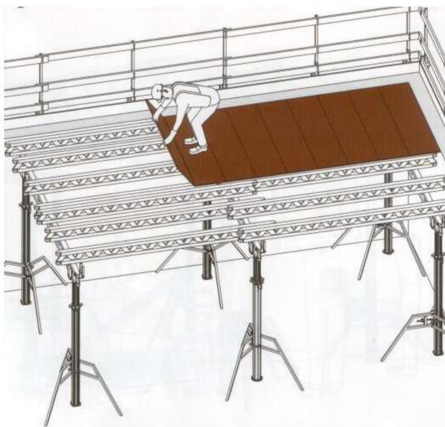
Рисунок 11 – Схема монтажа балок перекрытия
