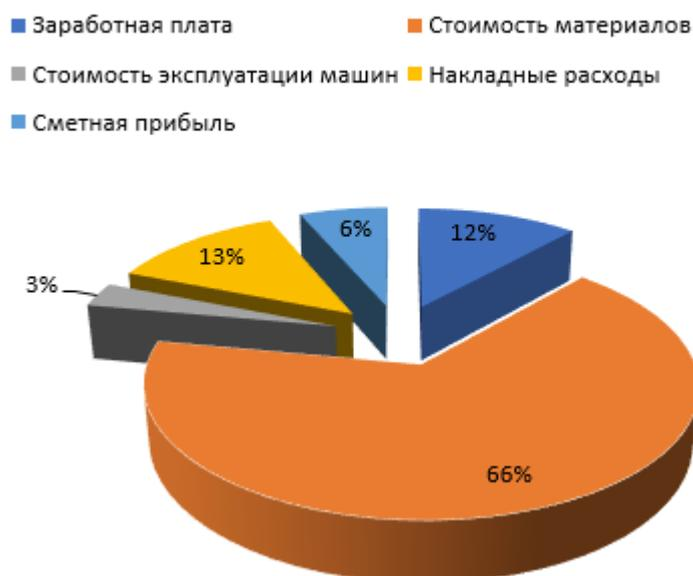
Рисунок 22 – «Диаграмма затрат на устройство монолитной плиты перекрытия» [27]
