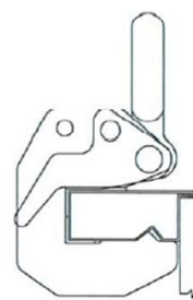
Рисунок 16 - Монтажный крюк для перемещения элементов опалубки
