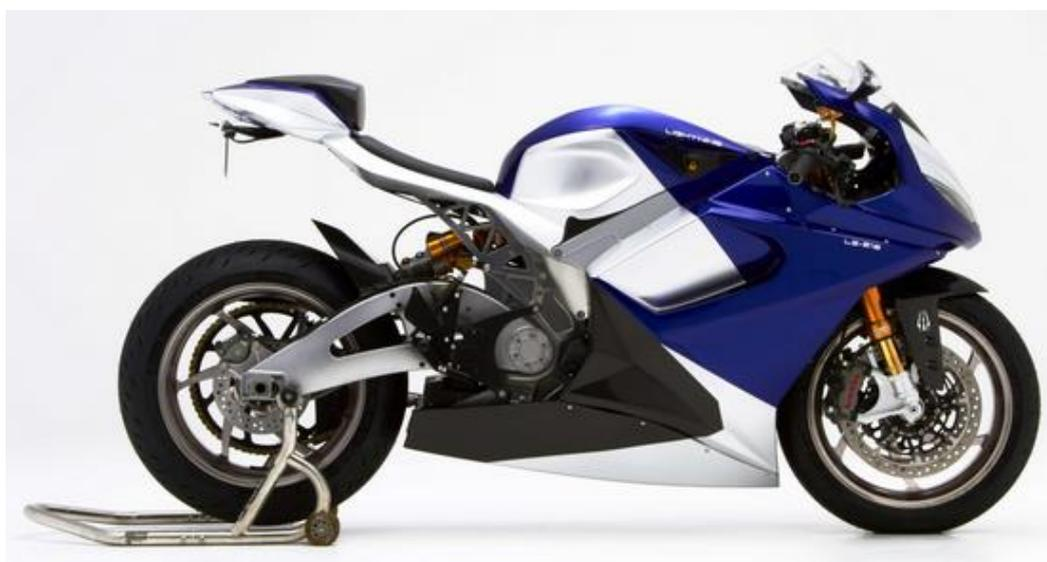
Рисунок 8 – Электромотоцикл Lightning LS-218
