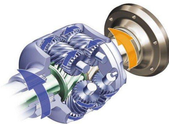
Рисунок 2 - Червячный дифференциал повышенного трения Torsen»[25]
