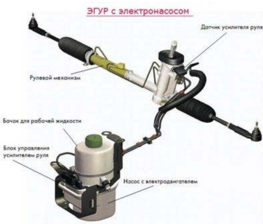
Рисунок 1 – Электрогидравлический усилитель рулевого механизма (ЭГУР) Servotronic (США)
