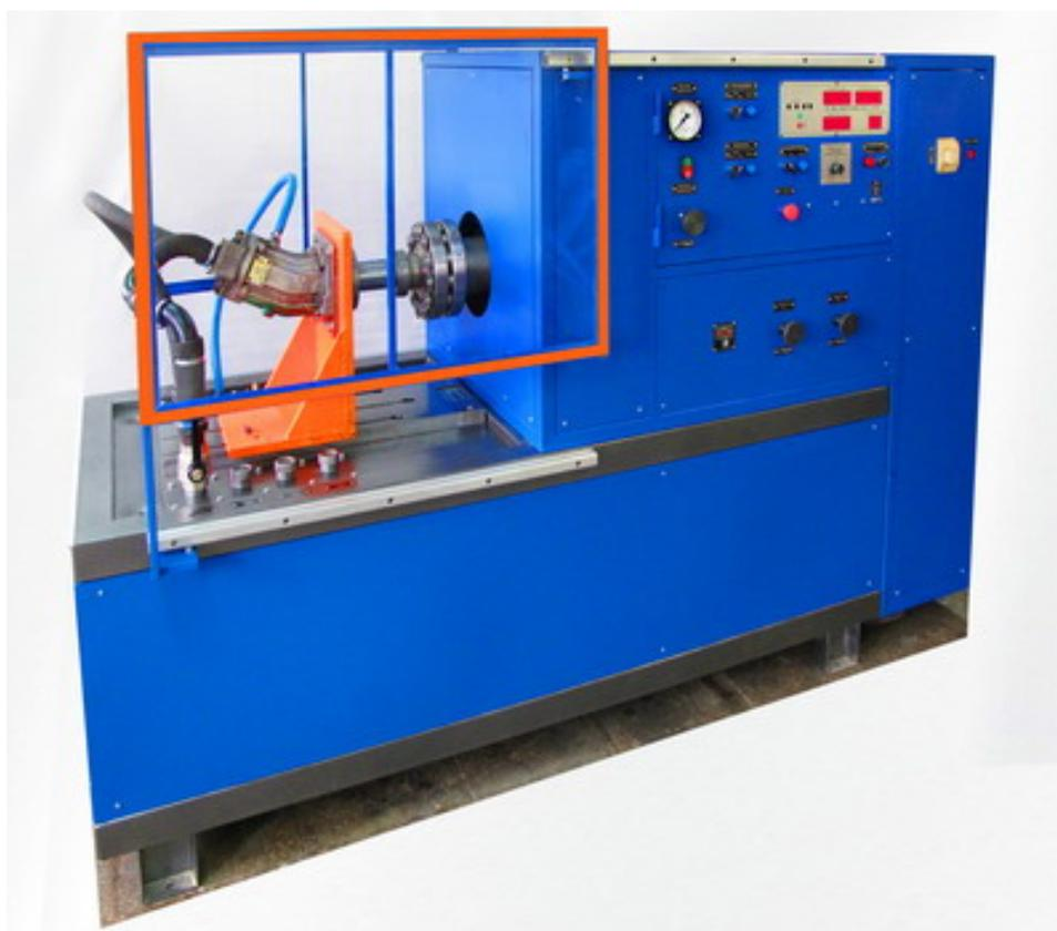
Рисунок 9 – Стенд для испытания усилителей рулевого управления
