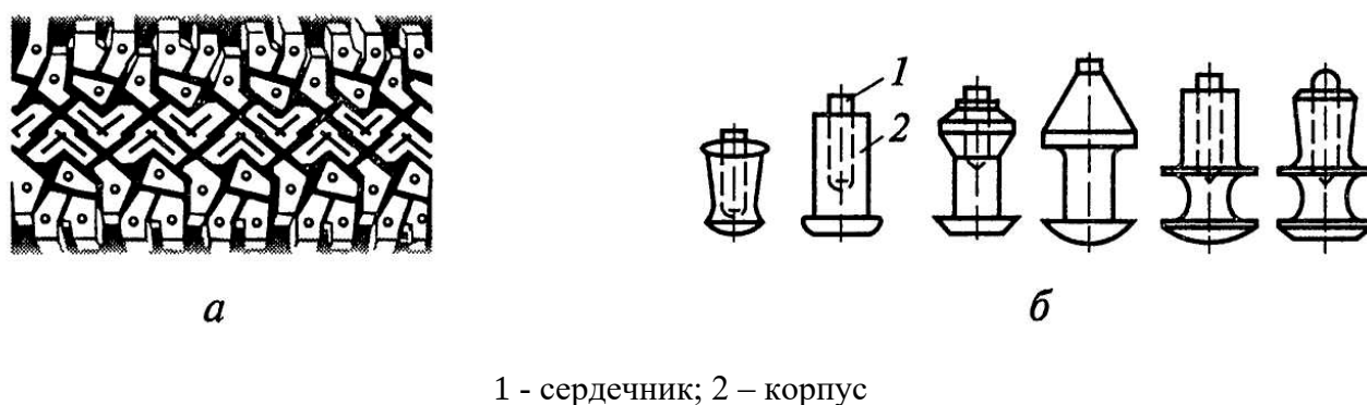
Рисунок 4 – Зимний рисунок протектора шины (а) и шипы противоскольжения (б)
