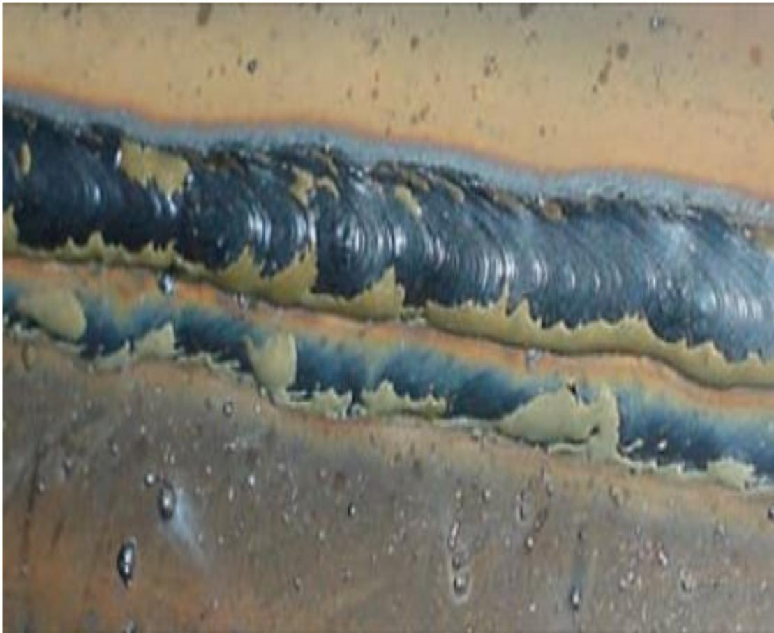
Рисунок 6 - Внешний вид шва, полученного дуговой сваркой в  $\text{CO}_2$
