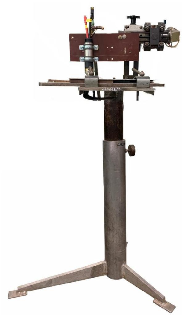
Рисунок 27 – Сварочный стенд ЛС-1
