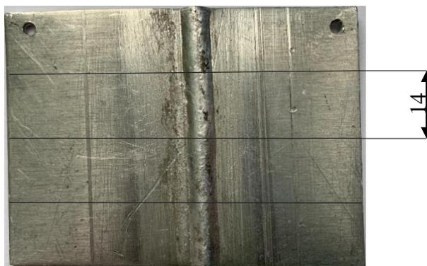
Рисунок 30 – Образец сваренный
