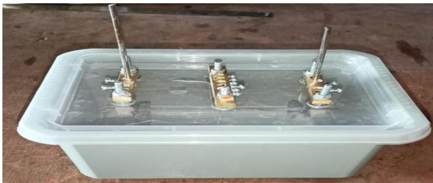
Рисунок 20 – Экспериментальная установка металлизации
