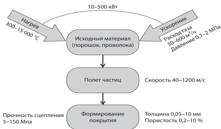
Рисунок 9 – Схема процесса ГТМ
