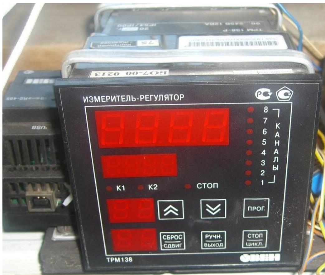
Рисунок 14 – Измеритель - регулятор универсальный ТРМ 138
