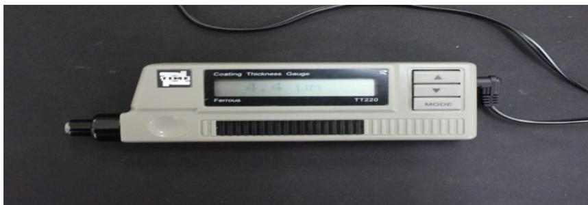
Рисунок 17 – Магнитный толщиномер TT220
