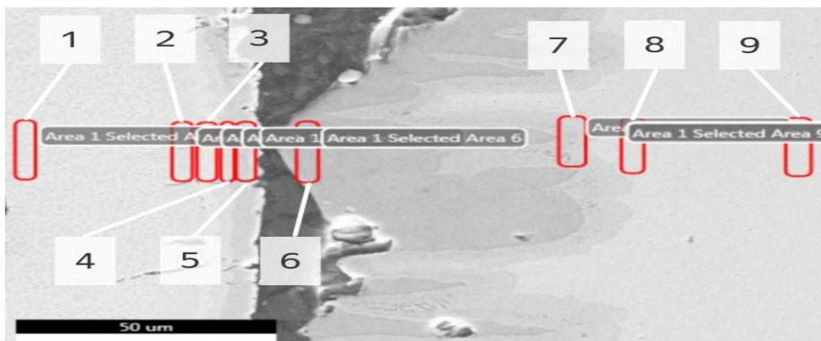
Рисунок 30 – Микроструктура 2 стального образца с нанесёнными покрытиями Fe- Ni-Al
