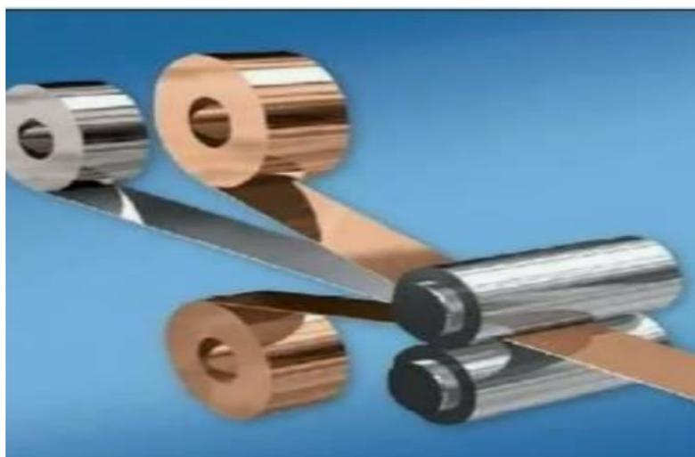
Рисунок 5 – Процесс плакирования
