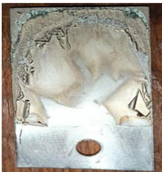
Рисунок 23 – Стальной образец с покрытием Al и последующим Ni
