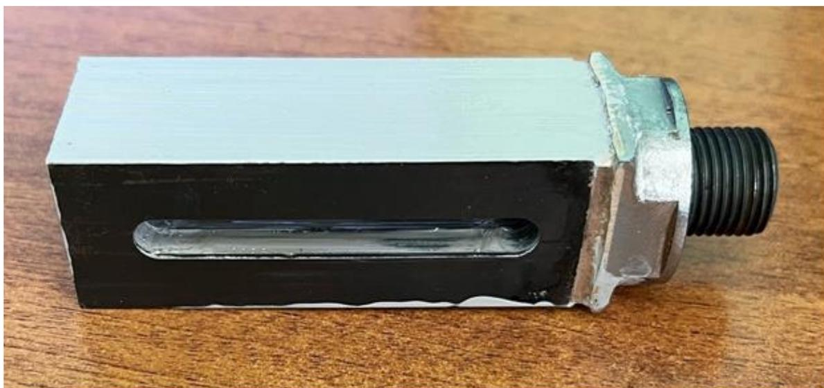
Рисунок 34 – Магнитостриктор сечением 26 на 26 мм
