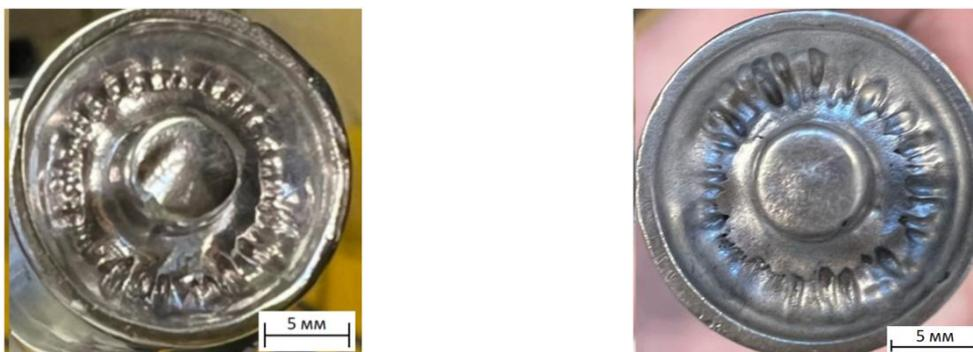
Рисунок 45 – Лучеобразный износ торцов волноводов
