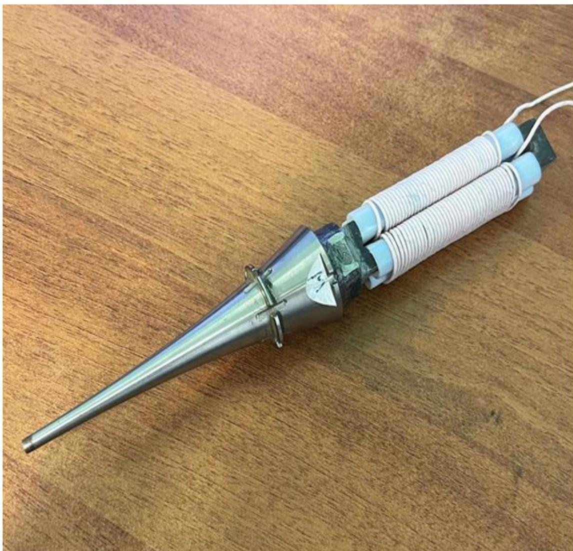
Рисунок 12 – Ультразвуковая колебательная система в сборе
