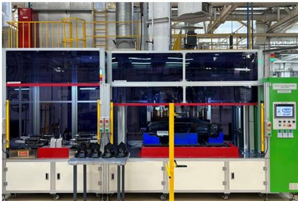
Рисунок 43 – Линия для ультразвуковой сварки дверной карты
