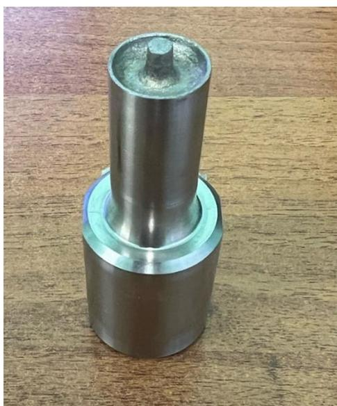
Рисунок 40 – Титановый волновод с покрытием
