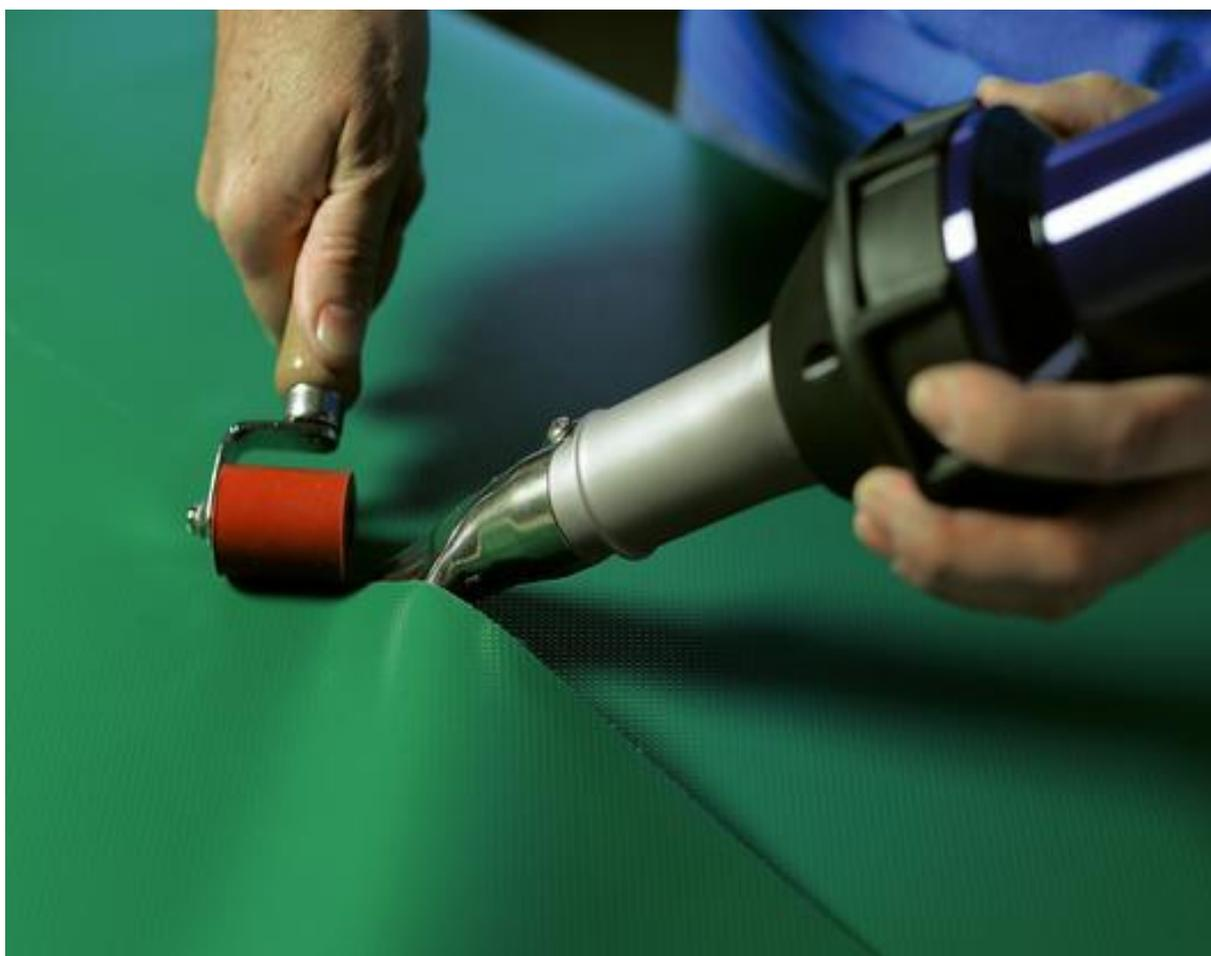
Рисунок 8 – Сварка нагретым газом
