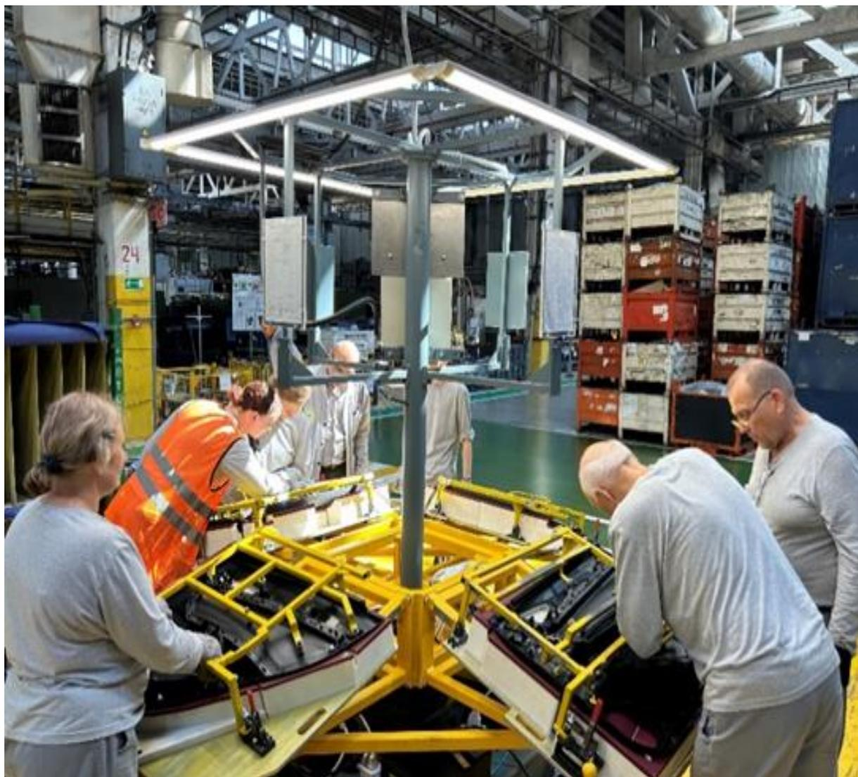
Рисунок 31 – Сборочный стенд дверных карт LADA Vesta
