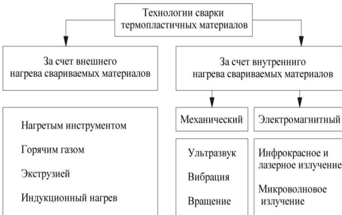
Рисунок 6 – Классификация способов сварки пластика
