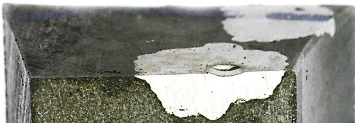
Рисунок 8 – Вид пятен в сечении после холодного макротравления. Глубина пятна не менее 2,95 мм
