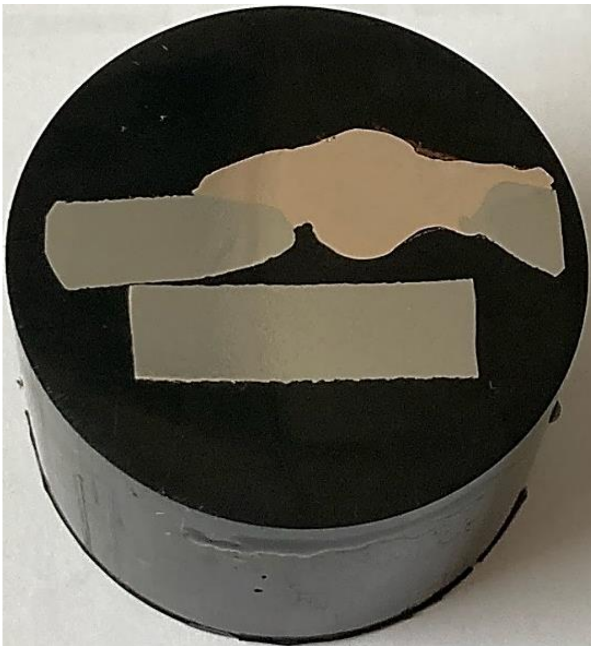
Рисунок 15 – Шлиф с залитыми в пластмассу темплетами фрагментов паяного соединения
