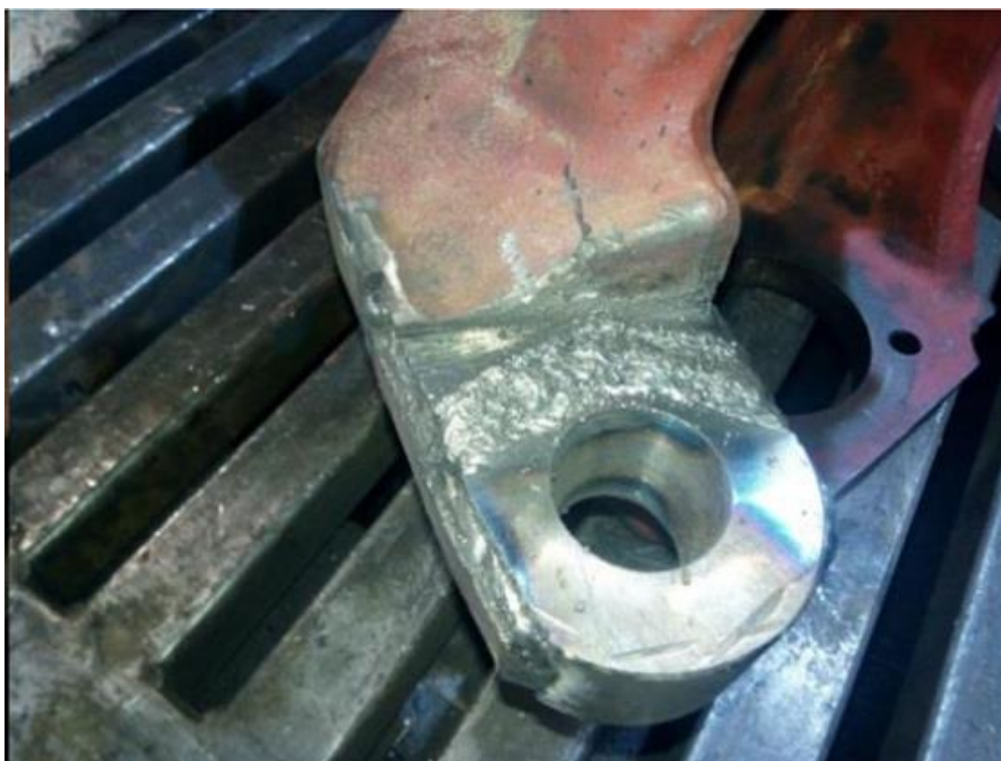
Рисунок 4 – Сварка чугунных деталей электродами ЦЧ-4
