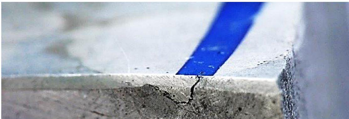
Рисунок 7 – Чернота по границе раздела основного и наплавленного металла на зеркале цилиндра
