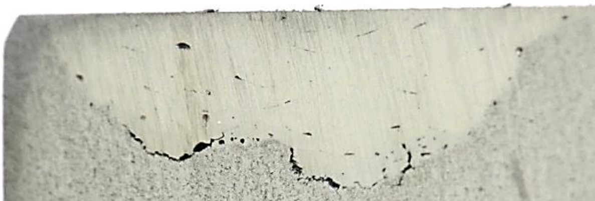
Рисунок 9 – Вид пятна в сечении – чернота, поры, загрязнения по границе раздела с основным металлом
