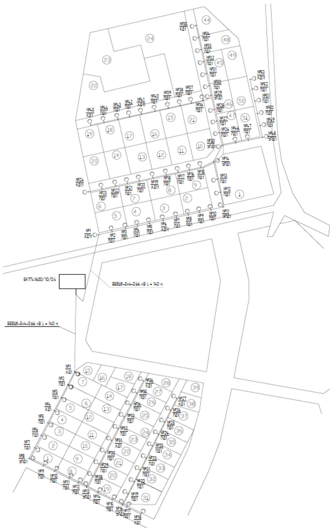
Рисунок 8 – План дачного поселка с указанием мест расположения светильников
