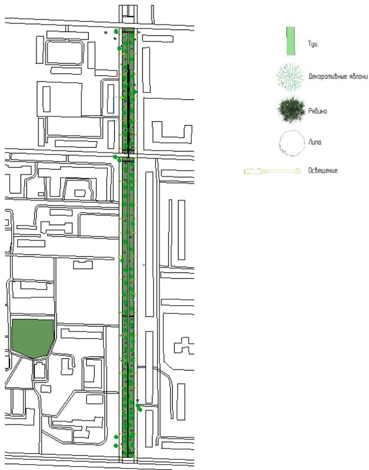
Рисунок 3 – Схема озеленения и освещения
