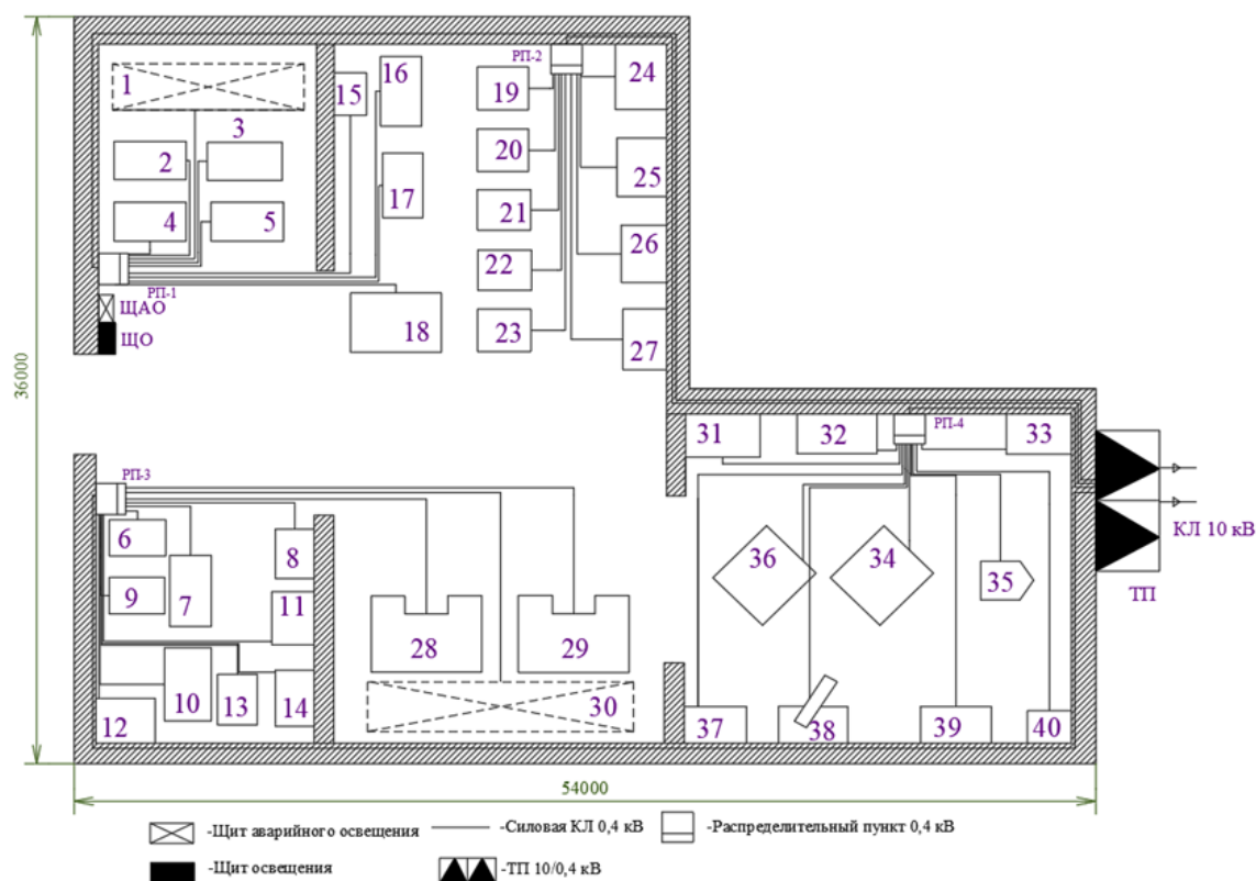
Рисунок 8 – План силовой сети цеха
