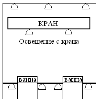
Рис. 6.4. Схема размещения светильников в цехе электролиза алюминия
