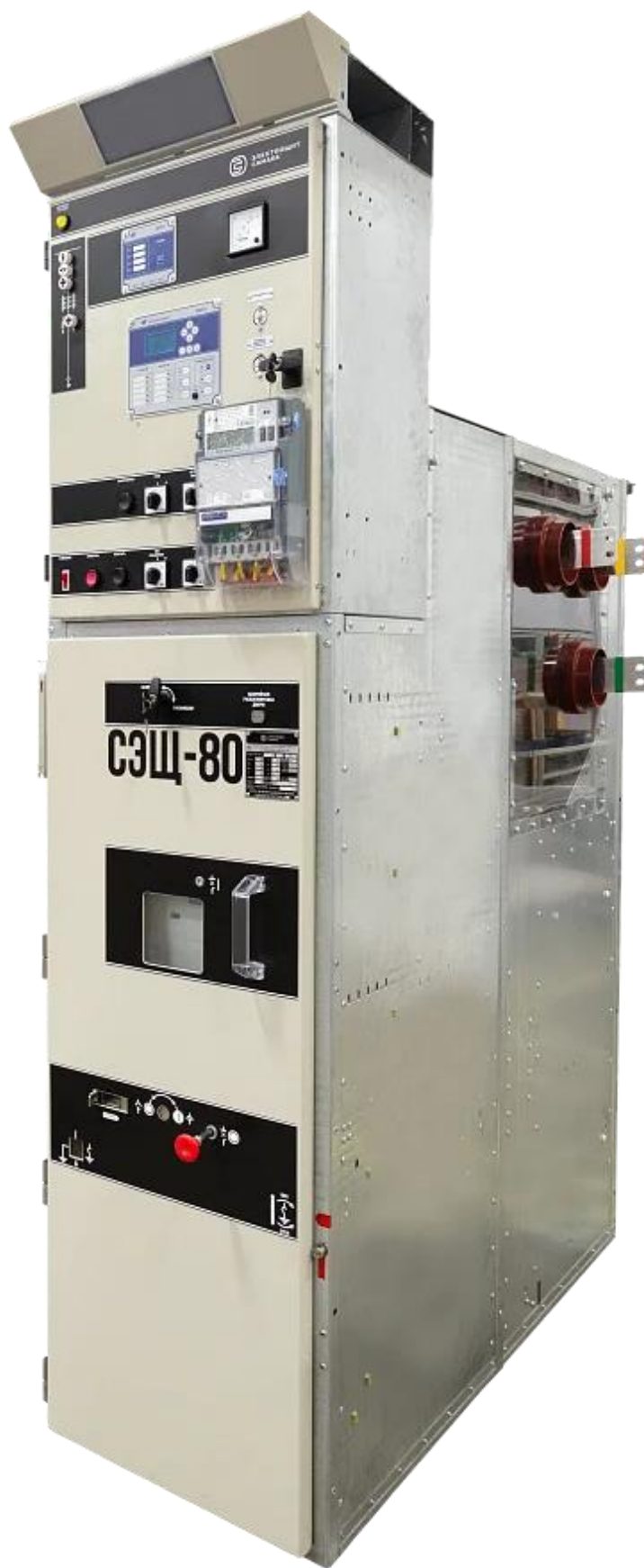
Рисунок 7 – Ячейка комплектного распределительного устройства с вакуумной изоляцией марки КРУ–СЭЩ–80-10Н кВ, производства ГК Электроцит – ТМ Самара
