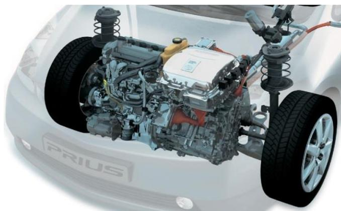
Рисунок 7 – Совмещенная система силового агрегата (ДВС и электромотора)” [10].
