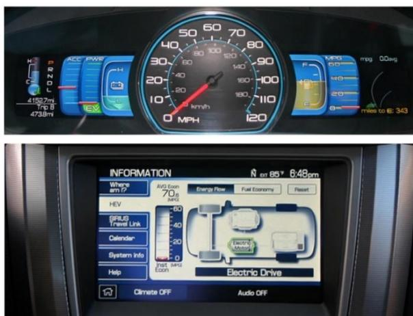
Рисунок 12 – Цифровые панели для отслеживания эко-стиля вождения (вверху) и текущей тяги (внизу).
