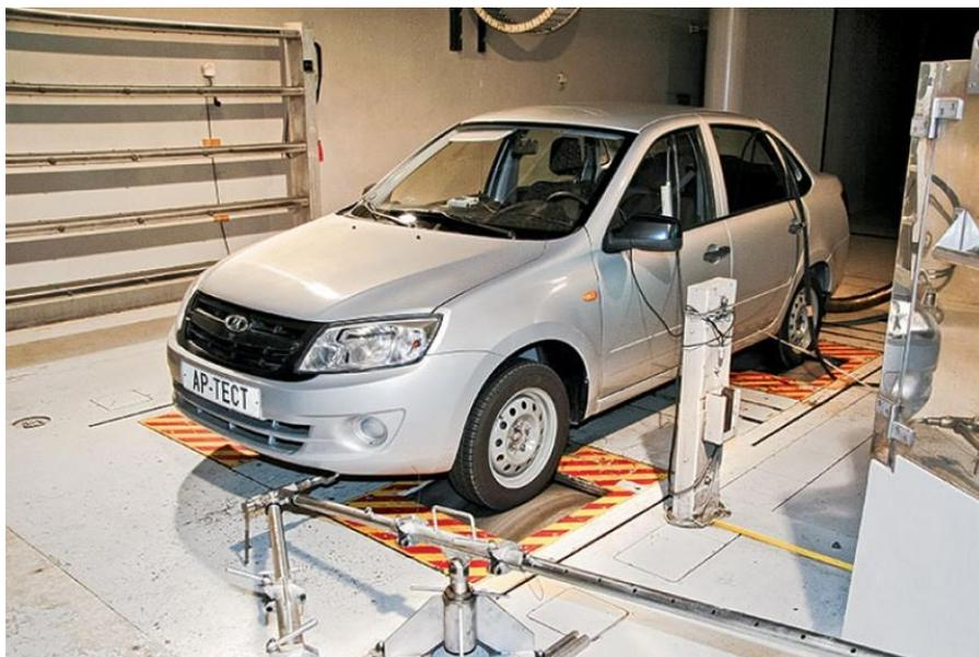
Рисунок 30 – стендовые испытания ездовых циклов
