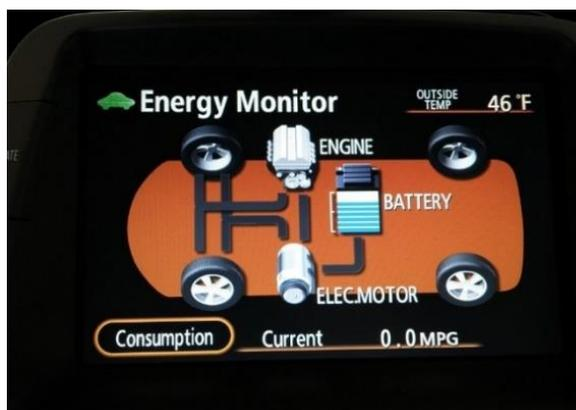
Рисунок 6 – Схема гибридного силового привода Toyota Prius: двигатель (Engine) и электромотор (Electromotor) вращают колёса и взаимодействуют между собой” [10]
