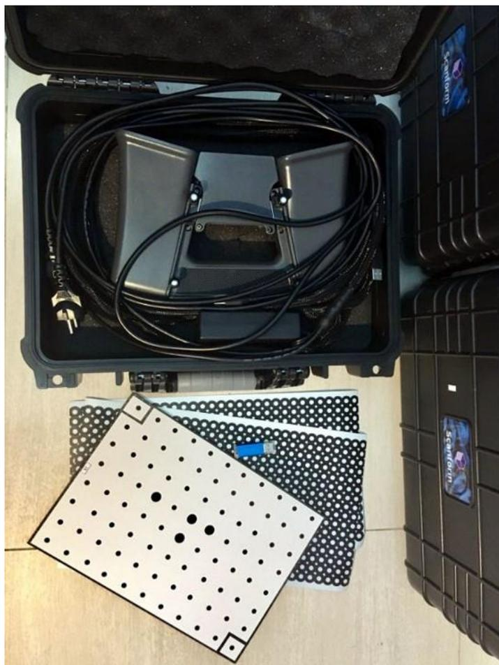
Рисунок 8 – Плитка для калибровки аппарата Scanform L5
