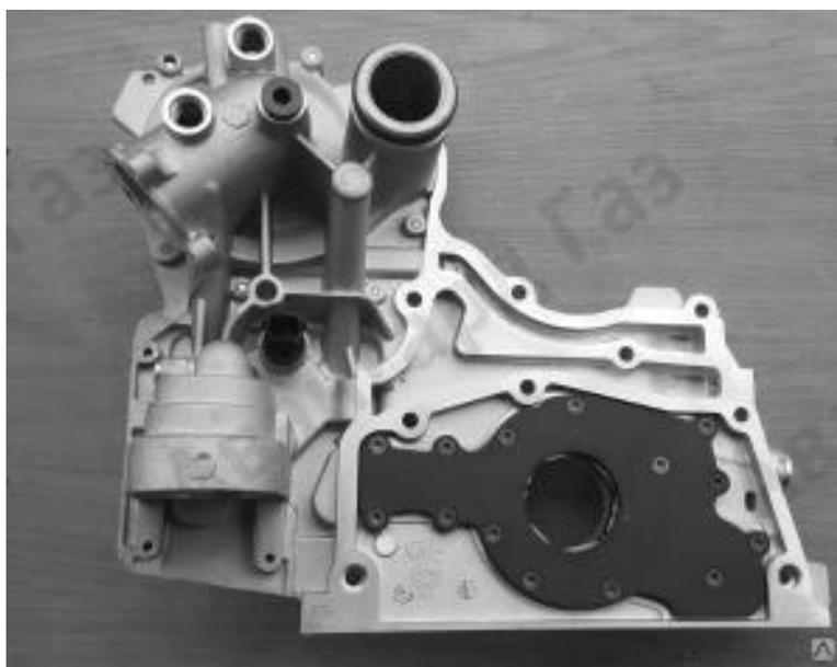
Рисунок 10 – Используемый в двигателе автомобиля ГАЗЕЛЬ НЕКСТ масляный насос
