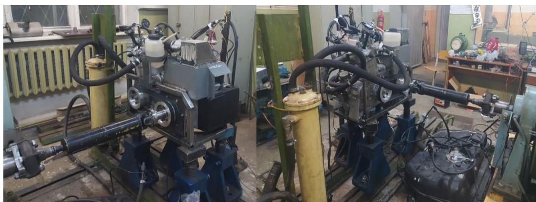
Рисунок 56 - Силовая установка на испытательном стенде
