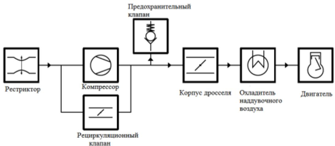
Рисунок 3 – Требование к установке рестриктора в автомобиль класса «Формула Студент» с турбокомпрессором
