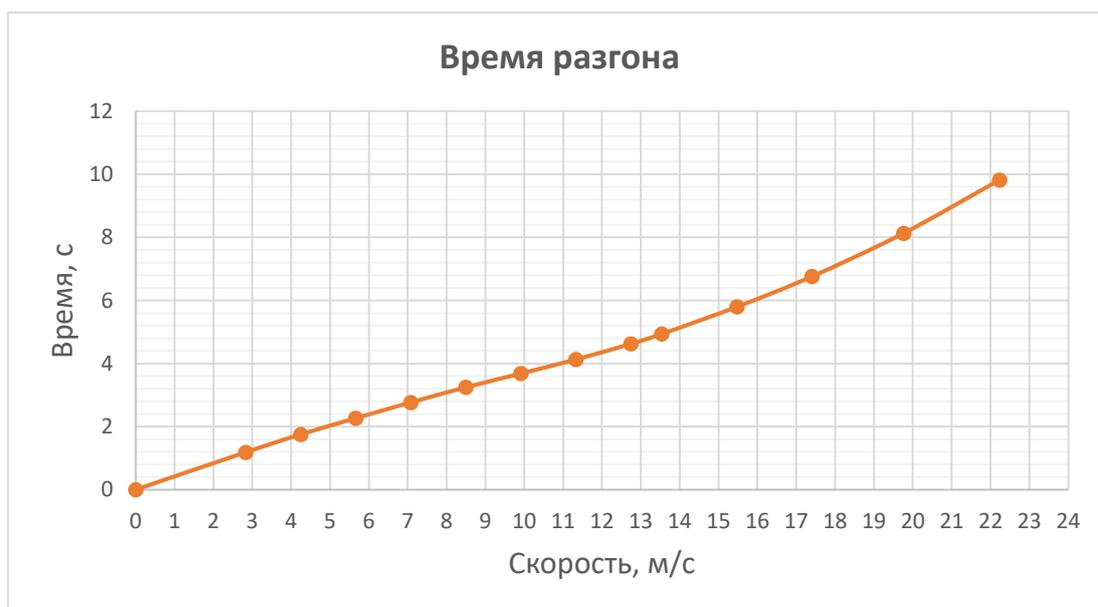
Рисунок 10 – Время разгона прототипа
