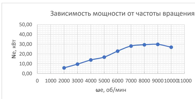
Рисунок 6 – График зависимости мощности от частоты вращения с испытаний
