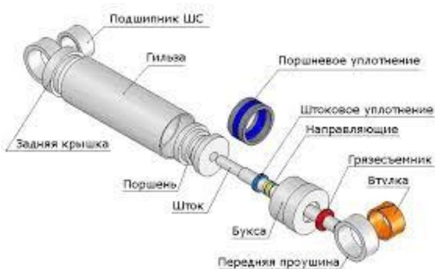
Рисунок 2 – Гидравлический цилиндр.
