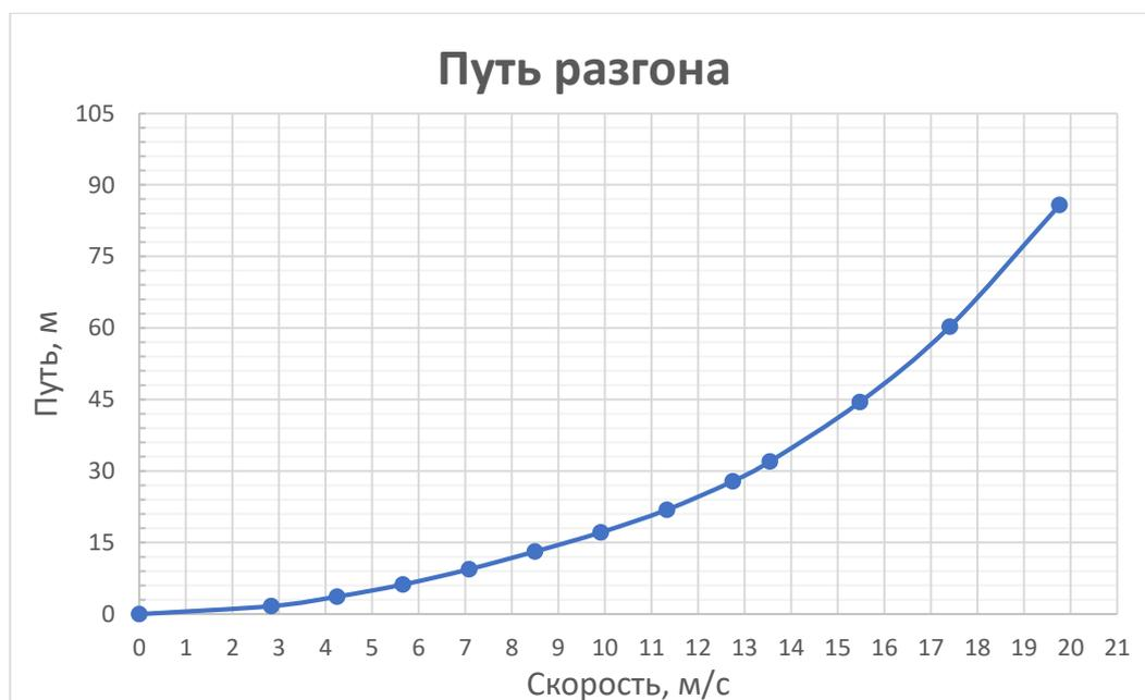
Рисунок 12 – Путь разгона прототипа
