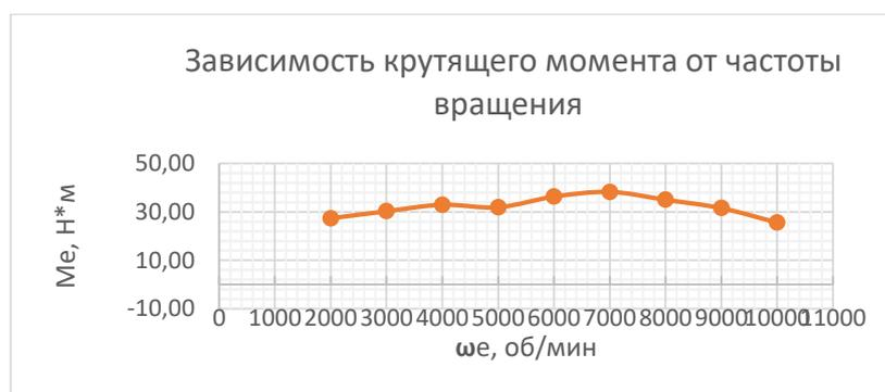
Рисунок 5 – График зависимости крутящего момента от частоты вращения с испытаний
