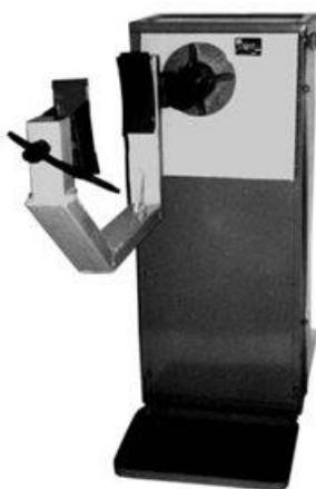
Рисунок 1 – Стенд для разборки и сборки гидромеханических передач автобусов Р 636
