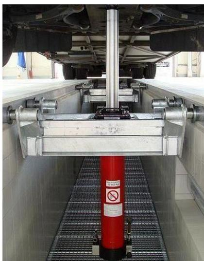
Рисунок 7 – Внешний вид подъемника JZ-RH 10/800 E
