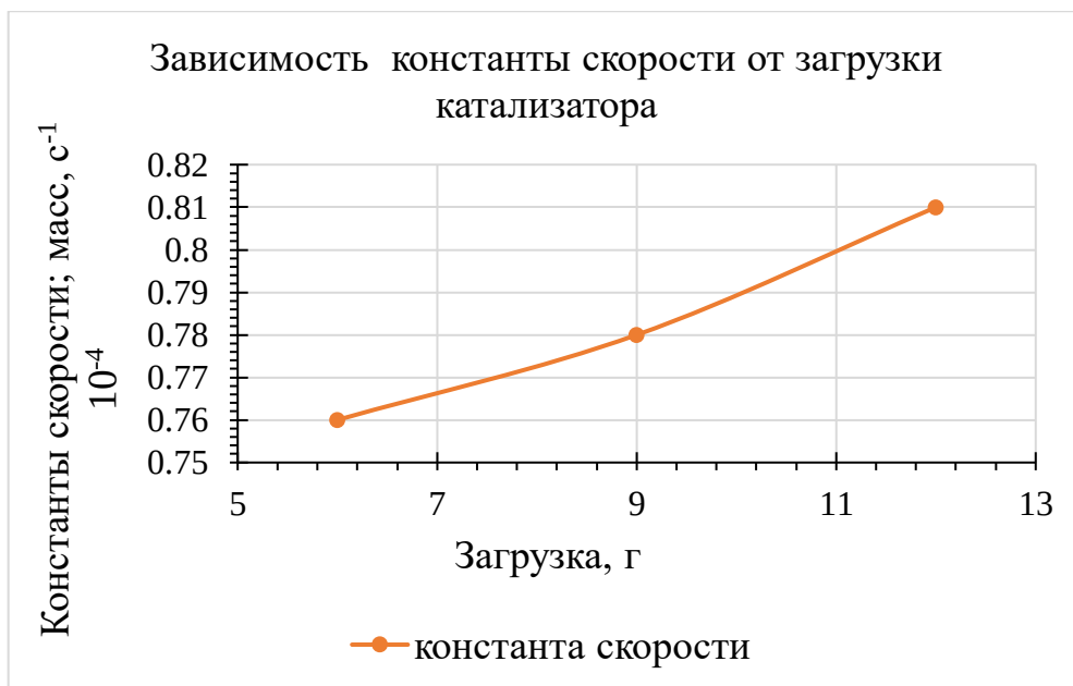
Рисунок 13 – Зависимость выхода эфира и константы скорости от загрузки катализатора
