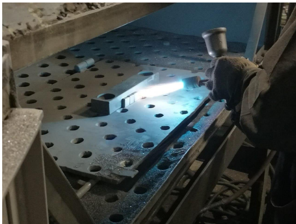
Рисунок 5 -Процесс нанесения покрытия
