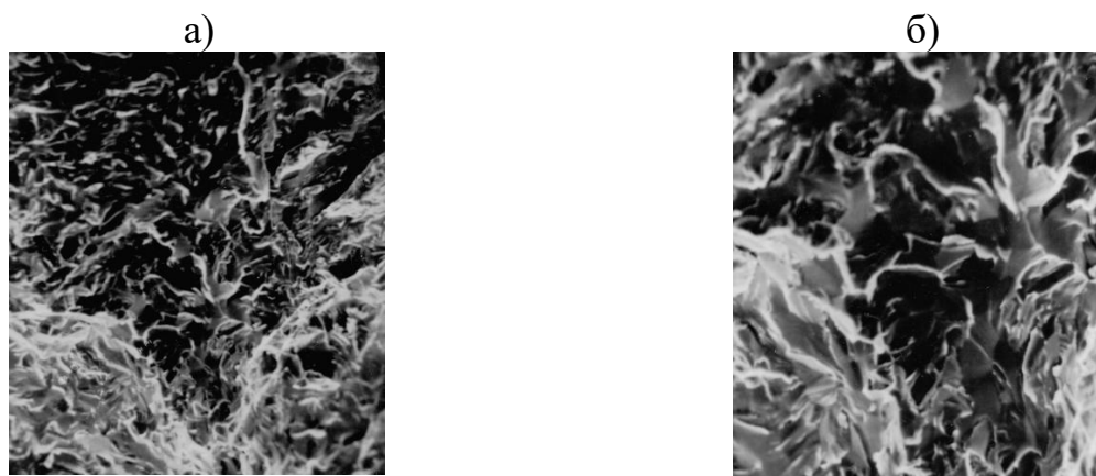
Рисунок 22 - Структура изломов хрома в состоянии поставки а) \times 200 , б) \times 500
