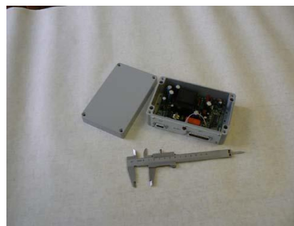
Рисунок 2 – Исполнение и размеры цифрового прибора контроля изоляции
