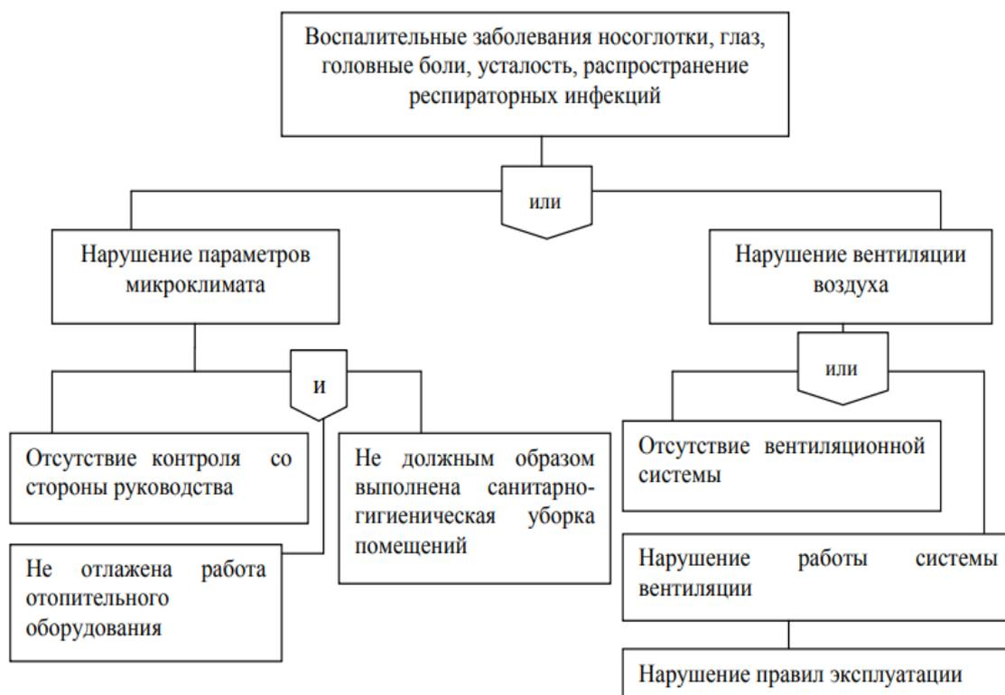
Рисунок 1 – «Дерево событий», для наиболее вероятного происшествия на рабочем месте лаборанта строительной лаборатории, выявленного экспертным методом
