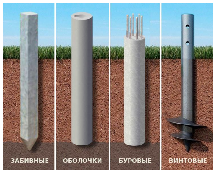
Рисунок 3 – Виды свай по способу заглубления
