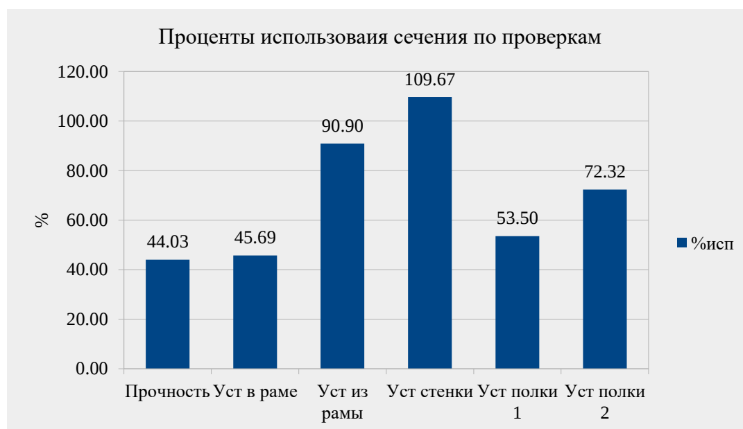
Рисунок 24 — Проценты использования сечения по проверкам
