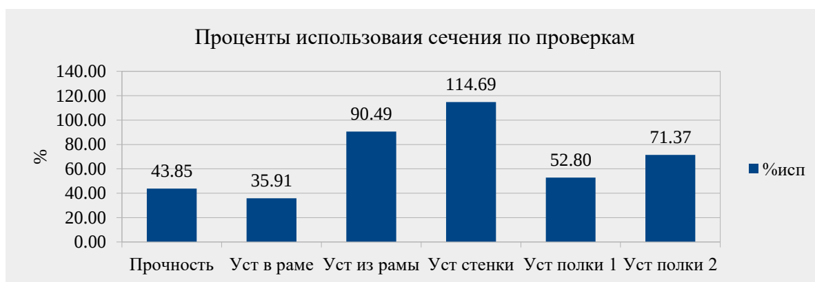
Рисунок 71 — Проценты использования сечения по проверкам колонны среднего ряда 1
