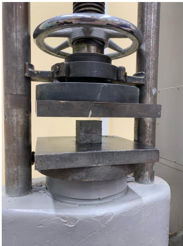
Рисунок 22 – Испытание образца на гидравлическом прессе
