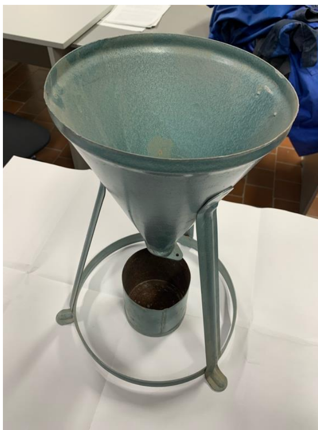
Рисунок 16 – Конус для определения насыпной плотности песка
