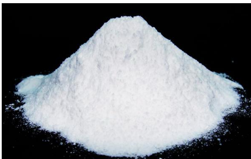
Рисунок 12 – Кристаллогидрат сульфата алюминия в виде порошка
