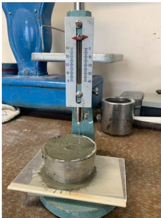
Рисунок 21 – Определение сроков схватывания цементного теста
