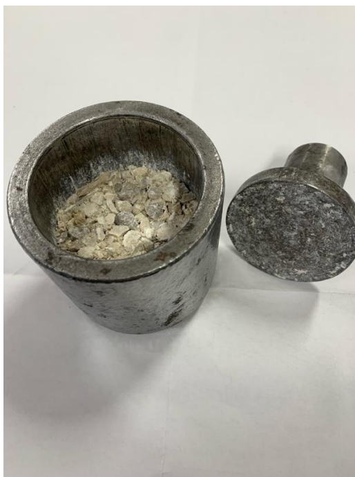
Рисунок 17 – Определение марки щебня по дробимости
